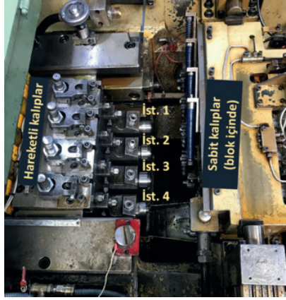
Şekil 3. Soğuk dövme kalıp sistemi. İncelenen zımba adaptörü 3. İstasyon hareketli blokta yer almaktadır.
