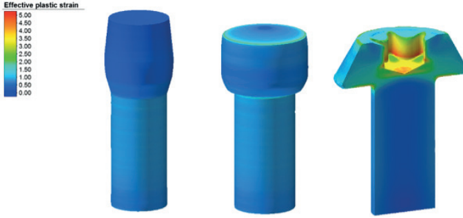
Şekil 8. İlk 3 istasyon için yapılan şekillenme simülasyonları sonucu elde edilen ara istasyon ürün formları.
