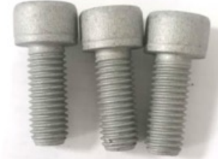
Şekil 9. Kaplama 2 uygulanmış yapılmış civataların tuz püskürtme testi sonucu.
