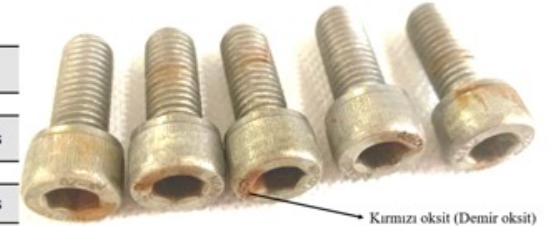
Şekil 6. Pasivasyon işlemi yapılmamış cıvataların tuz püskürtme testi sonucu.
