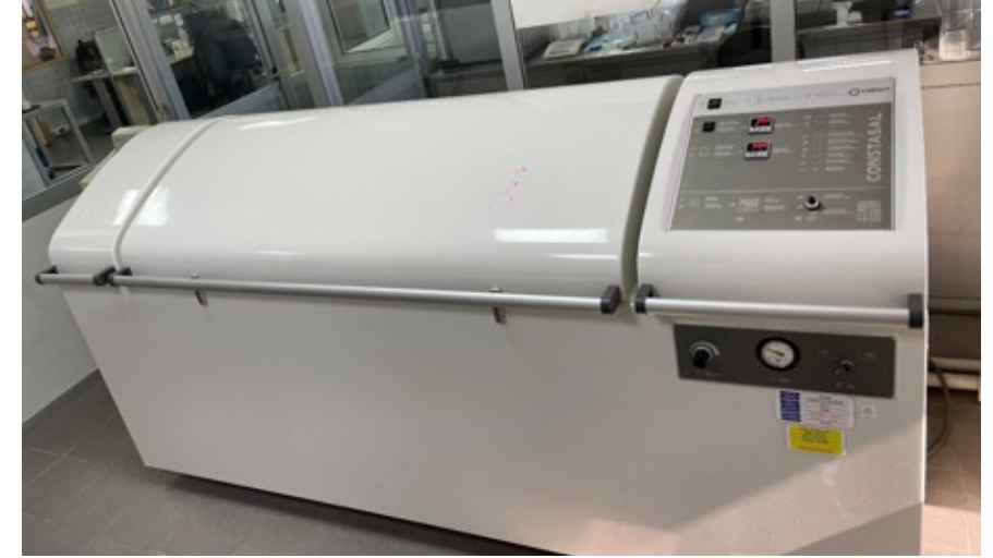
Şekil 5. Liebisch Model: 42016101 tuz püskürtme testi kabini.
