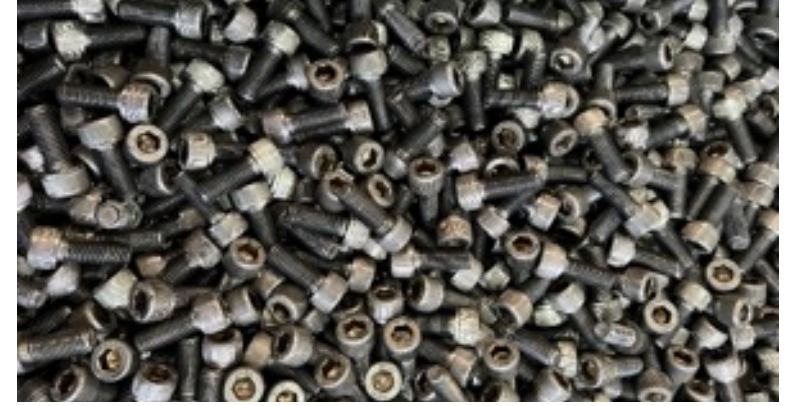
Şekil 3. Üretilmiş M10x25 DIN912 A2-70 paslanmaz test civataları.
