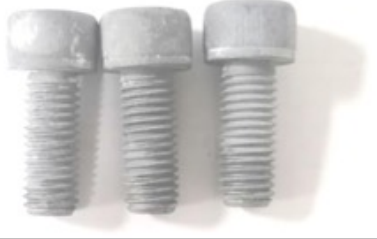
Şekil 8. Kaplama 1 uygulanmış civataların tuz püskürtme testi sonucu.
