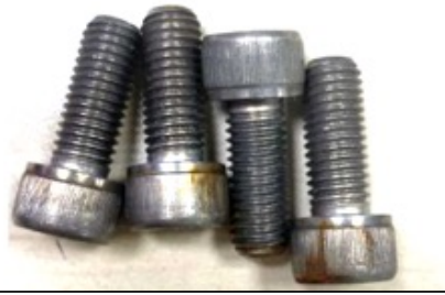
Şekil 7. Pasivasyon işlemi yapılmış civataların tuz püskürtme testi sonucu.
