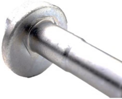
Şekil 3. Çakma prosesiyle üretilmiş kamber cıvatası numunesi.
