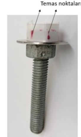
Şekil 1. M8x1,25 DIN 933 cıvata için torklama testi sonrası temas alanlarının belirlenmesi.
