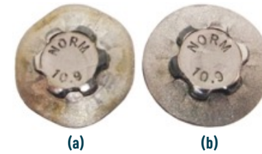
Şekil 3. Vurucu kalıp yüzeyinin papatyalanmaya etkisi; (a) mevcut tasarım, (b) kaba pürüz verilmesi.
